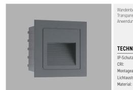
Wandeinbauleuchte für den Aussenbereich, ausgestattet mit SMD-LEDs. Gehäuse aus Aluminiumdruckguss, lackiert. Einbaubox aus Polycarbonat enthalten. Transparenter Diffusor aus Polycarbonat. LED-Treiber enthalten. Gummidichtung an der Kabeleinführung. Kabellänge 10cm Anwendungsbereich: dekorative Aussenbeleuchtung.
