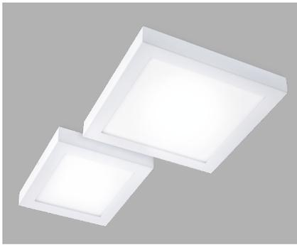
Eckige Decken- und Wandbauleuchte bestückt mit SMD LED. Hohe Lebensdauer und Energieeffizienz. Gehäuse aus Aluminiumdruckguss, lackiert. Diffusor aus Polystyrol mit Siebdruckgitter und Polyethylenreflektor. Konstantstrom-LED-Treiber ist in der Leuchte integriert.
