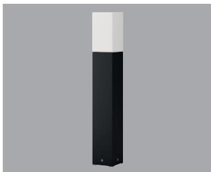
Pollerleuchte MEGA-SQUARE aus korrosionsbeständigem Aluminium für Aussenanwendung, pulverbeschichtet. Mit voll umschlossenen Befestigungssockel aus Edelstahl. Korrosionsfreier Leuchteneinsatz aus Dualcompound Spritzguss mit integriertem Dichtungselastomer. Abdeckung Glas opal seidenmatt, mundgeblasen. Betriebsgerät eingebaut. Serienmässig mit Membranventil zur Kondenswasservermeidung. Anschlussdose am Sockel für Anschluss von max. 2 x 3 x 2,5mm<sup>2</sup> als Durchgangsverdrahtung.
